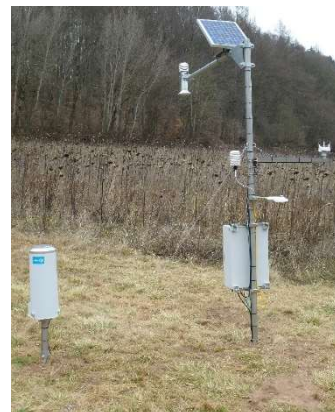
Wetterstation u. a. mit Schneehöhensensor und Nettoradiometer
