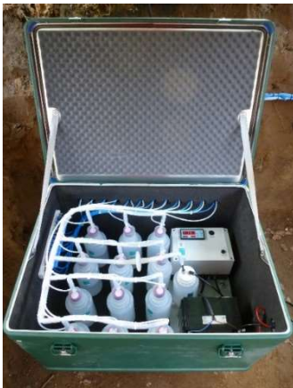
Alubox mit elektronischer Vakuumregelung, Stromversorgung und Sammelflaschen für die Saugplattenanlage
