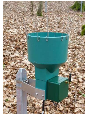
Niederschlagskippschale mit Remote-Funklogger
