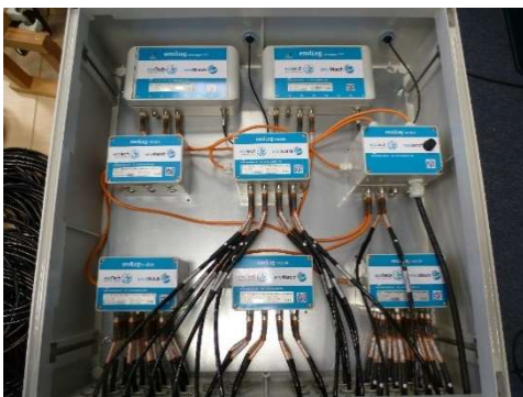
Alubox mit elektronischer Vakuumregelung, Stromversorgung und Sammelflaschen für die Saugplattenanlage
