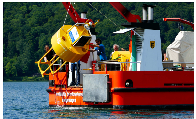
Bild 4: Forschungsschiff „Kormoran“ bei der Ausbringung der Messboje an ihrem Einsatzort
