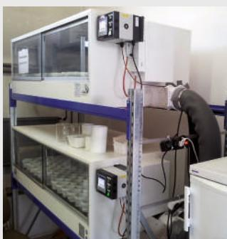
Angetrieben durch die langsame Austrocknung der Bodenproben durch den Extraktor, streben die überlebenden Organismen dem gekühlten Bereich entgegen und sammeln sich in einer Fangflasche.
