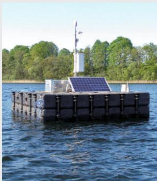
Automatisierte Erfassung der Wasserqualität in verschiedenen Wassertiefen sowie von meteorologischen Messdaten, Datenversand per GPRS, autarke Stromversorgung (Brennstoffzelle, Solarstrom).
