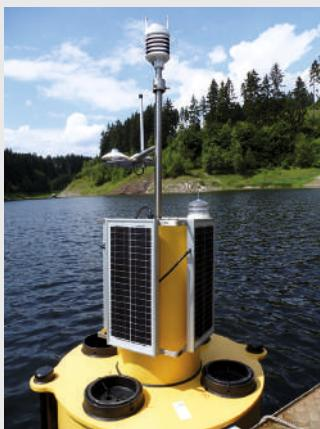
Erfassung der Wassertemperatur in 25 Tiefen sowie von meteorologischen Messdaten, Datenversand per GPRS, autarke Stromversorgung (Solarstrom).
