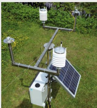
Automatisierte Erfassung von meteorologischen Messdaten mit jeweils doppelter Sensoranordnung auf gleicher Messhöhe, Datenversand per GPRS, autarke Stromversorgung (Solarstromversorgung).
