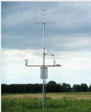
Messung von Globalstrahlung, Lichtintensität und weiteren Wetterparametern, Datenversand per GPRS, autarke Stromversorgung (Solarpanel, Batterie).
