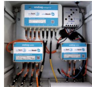
b) Zentraler Datenlogger mit Untereinheiten für Teilparzellen, Entfernung bis 100 m
