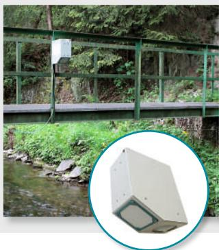
Montage und Kalibrierung des Messinstruments (RQ-30) an der Lahn. Zweimonatige Messkampagne zur Erfassung des Durchflusses, inkl. Datenversand per GPRS, autarke Stromversorgung (Batteriebetrieb).
