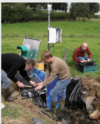
Kooperationsprojekt u.a. mit automatischer Messung von Abfluss, meteorologischen Daten und Wasserqualität, inkl. Entnahme von Gewässerproben, Datenversand per GPRS, autarke Stromversorgung (Brennstoffzelle, Batterie).
