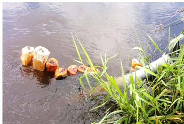
Bild 2: Einbau einer EX01 Multiparametersonde im Rohr mit Prallschutz gegen Treibgut. Quelle: Lukas, LLUR
