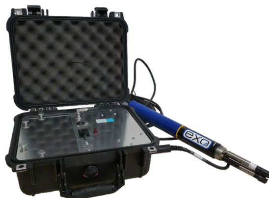
Bild 5: ecoTech enviLog Mobil mit angeschlossener EXO 1 Multiparametersonde von YSI. Quelle: ecoTech Umwelt-Meßsysteme
